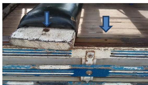
Foto 8: Tábua acolchoada, que serve de assento, solta. As setas indicam o desencontro entre os orifícios de fixação da tábua à carroceria do veículo.
