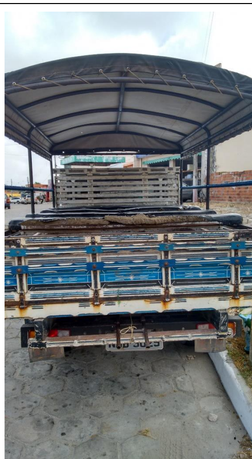
Foto 6: Parte traseira do veículo; os assentos são tábuas acolchoadas, que já apresentam desgaste.
